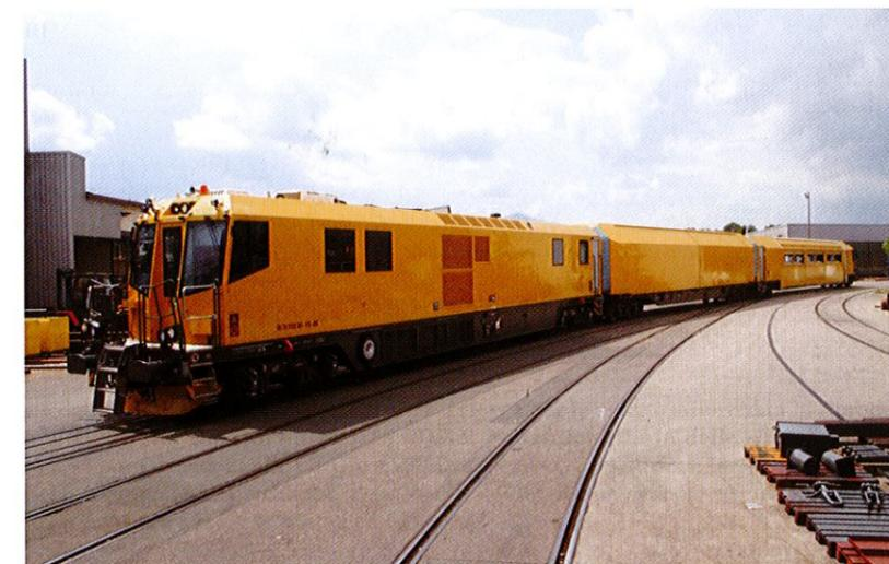
Fig. 6 - Sistema di Manutenzione Mobile MIS 69.70.
