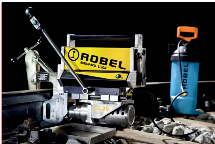
Fig. 1 - Il forarotaie a batteria
