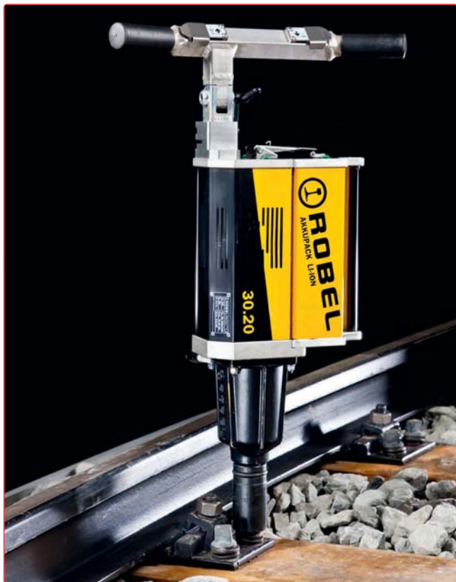
Fig. 2 - L'incavigliatrice a percussione a batteria
